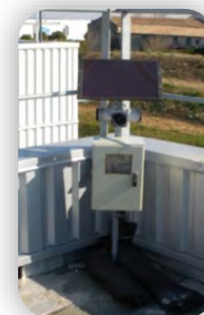
Effaroucheurs électroniques : cris de prédateurs (à gauche) - cris de mouettes en détresse (à droite)
